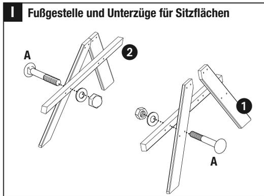
Trocknungsbedingt kann es sein, dass Bohrungen nicht genau überein passen. In diesem Fall bohren Sie die Löcher mit 8 mm nach.
