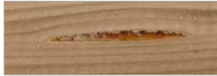
Harzgallen mit Entharzer entfernen
